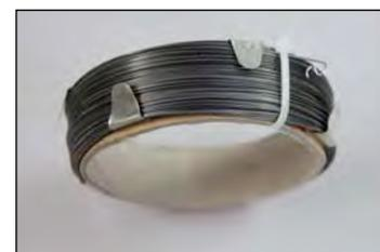
Das Vierkant-Profil des Schneidrahtes ermöglicht eine leichtgängige, exakte und saubere Schnittleistung selbst durch stärkste Polyurethanschichten. Dieser Vierkant-Draht ist mit einer Speziallegierung gefertigt, um extrem starke Zugfestigkeiten über 2.400 MPa zu gewährleisten und das gefährliche „Abreißen“ unter Zuglast zu verhindern. Absoluter Profidraht für den professionellen Scheibenwechsel.
