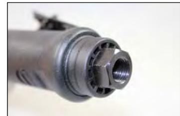
Geräuschreduzierter und vibrationsarmer 10mm Bandschleifer mit Kunststoff isoliertem Handgriff. Zum Einstellen der optimalen Arbeitsposition, lässt der Griff sich um die Antriebsrolle um 360° schwenken. Einfacher Schleifbandwechsel durch Schnellspann-Vorrichtung. Einstellung der Luftzufuhr erfolgt über ein Regulier-Ventil.
