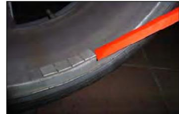
Klebegewichts-Entferner aus hochwertigem Kunststoff zum mühelosen u. beschädigungsfreien Entfernen von Klebegewichten und deren Rückständen. Kein Zerkratzen der Alufelgen! Darüber hinaus vielfältige Einsatzmöglichkeiten, wie z.B. Abschaben von Etiketten und Plaketten. Lösemittelbeständig. Griff mit Aufschlagphase für Hämmer.
