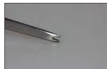
Die Durchstech-Ahle ist konzipiert worden, um den Schneiddraht auch an tiefliegenden Armaturenbrettern leicht durch den PU-Kleber führen zu können. Die Spitze ist als spezielle Führungsgabel ausgestaltet, in die der Draht bequem eingelegt werden kann. Um sich auch den unterschiedlichen Wölbungen der Armaturenbretter hervorragend anpassen zu können, ist das Schwert aus hochflexiblen Federstahl gefertigt. Über den T-Griff kann der richtige Arbeitsdruck ausgeübt werden.
