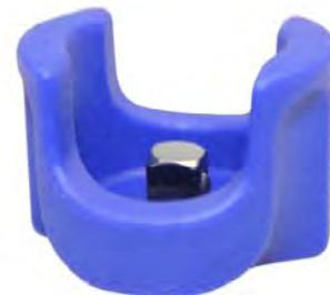
Mini-Stummel-Bithalter mit 1/4" Antriebs-Vierkant für alle üblichen 1/4" Steck-Adapter. Der tiefliegende Vierkant minimiert die Bauhöhe auf das kleinstmögliche Maß. Damit können nun erstmals Verschraubungen in sehr engen Bereichen bequem gelöst oder handfest angezogen werden. Die großen seitlichen Aussparungen erlauben einen sehr guten Zugang zu den Aufsätzen und deren bequemes Auswechseln. Ideal für verschraubte Schlauchschellen, Innenverkleidungen, Radkästen, kurz: überall, wo es eng wird.
