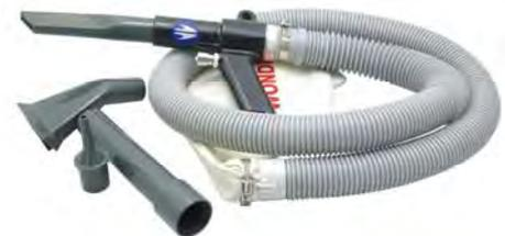
Druckluft-Sauger mit Venturi-Effekt. Robuster Metallgriff für unterschiedliche Düsenaufsätze und Absaugschlauch mit auswasch- und wiederverwendbaren Auffangbeutel. Ideal zum sicheren Aufsaugen von spitzen und gefährlichen Gegenständen wie Glassplitter, Metallspäne oder explosiven Metallstäuben. Oft verwendet zum Aufsaugen von Wasserlachen in Autoreifen oder zum Pumpen von Flüssigkeiten über geringe Höhenunterschiede. Wird auch zum großflächigen Trockenblasen und zum Luftkühlen genommen.
