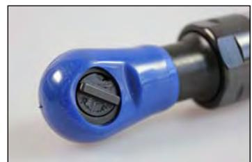
Mit nur 165mm Länge ist die B-2338 eine extrem kurze 3/8" Ratsche für Arbeiten an schwer zugänglichen Stellen. Die Ablufführung wird durch den Handgriff nach hinten geleitet. Der Ratschenkopf ist durch eine Gummimanschette vor Verschmutzungen und Beschädigungen geschützt. Die Luftzufuhr kann über eine Einstellschraube reguliert werden.
