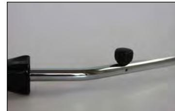
Der extra lange Gegenhalter erleichtert das Führen und Ziehen des Schneiddrahtes im Fahrzeug. Insbesondere bei tiefen Armaturenbrettern und langgezogenen Windschutzscheiben ist dieses Werkzeug alternativlos. Der Handgriff ist aus schlagfestem Kunststoff gefertigt, der Schneiddraht wird über eine Feststellschraube geklemmt.
