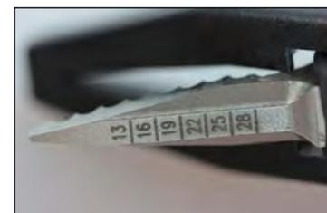
Ermöglicht den erforderlichen V-Ausschnitt der Ausspritzdüsen von Scheibenklebern und sorgt immer für eine optimale Dreiecks-Kleberaupe.
