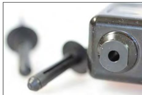
Für alle Reparaturen an plastikgenieteten Teilen, wie z.B. Stoßstangen, Radkasten-Abdeckungen (BMW) etc. Der um 90° gedrehte Nietkopf und die schlanke Bauform dieser Nietzange ermöglichen das Setzen von Nieten speziell in engen und schwer zugänglichen Bereichen. So kann z.B. bequem in Radkästen – speziell in einigen BMW-Modellen – genietet werden, ohne vorher die Räder zu demontieren.
