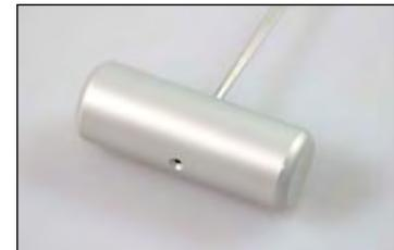
100 mm lange Drahtführungssonde als T-Griff ausgeformt, um den richtigen Druck beim Durchstechen der PU-Kleber ausüben zu können. Die Nadelsonde ist aus hochwertigem Werkzeugstahl gefertigt, spitz und scharfkantig, damit die PU-Kleber leicht zu durchstoßen sind. Die Sondenbohrung ist für Vierkant- und Piano-Draht ausgelegt.
