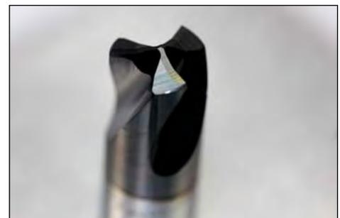
Vollhartmetall- (VHM-) Bohrer für höchstfeste Bleche (Usibor), die z.B. in den Rahmenquer- und Längsträgern, aber z.T. auch in Schwellern oder A- u. B-Säulen bei einigen Modellen von Audi Daimler/Chrysler, Porsche, VW, BMW, Volvo, Peugeot und vielen anderen verarbeitet werden. Für alle höher- und höchstfesten Bleche mit einer Zugfestigkeit von  $450\text{N/mm}^2$  –  $1.580\text{N/mm}^2$  (DC04 (St 14), Bake-Hardening bis Martensitphasen-Bleche).
