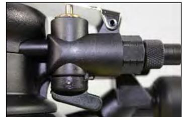
Extrem leichter, geräusch- und vibrationsarmer Exzentrerschleifer mit 5 mm bzw. 2,5 mm Exzenterhub, der für einen schnellen und hohen Abtrag sorgt. Die Maschine kann an eine Staubabsaugung angeschlossen werden. Sie ist leicht, liegt gut in der Hand und für den Dauereinsatz bestens geeignet. Das Schleifbild ist sehr gleichmäßig und für alle Schleifarbeiten auf unterschiedlichen Oberflächen ausgelegt.
