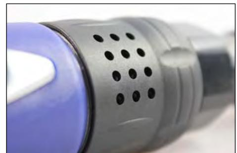
Leistungsstarke 1/2" bzw. 3/8" Druckluft-Ratsche mit einem Präzisionsgetriebe für eine höhere Kraftübertragung. Gummierter Handgriff zur Kälteisolation und zur Verringerung der Vibrationen. Abluftführung durch den Griff nach hinten. Drehzahl über Einstellschraube regulierbar. Rechts-/Links Umschalter am Ratschenkopf.
