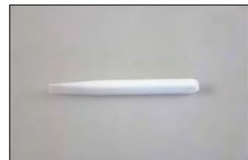
Die Einsatzbereiche finden sich überwiegend im Fahrgastraum, zum Lösen von Innenverkleidungen, Abdeckungen, kleinen Schaltern oder hochwertigen Chromverzierungen. Handelsübliche Kunststoffkeile sind nicht so standfest, fransen aus und werden schnell unbrauchbar. Ein Schraubendreher hingegen verursacht Kratzer, die dem Kunden sofort ins Auge springen.
